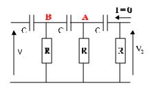
Le montage est alimenté par une tension sinusoï dale. Étudier le montage quand celui-ci possède une, deux puis trois cellules. Dans tous les cas, la dernière cellule n'est pas chargée. Calculer la fonction de transfert complexe  $H(j\omega)$  du montage. On posera  $x = RC\omega$ .
