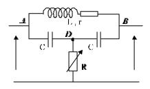
Calculer en régime sinusoï dal la fonction de transfert  $H(j\omega) = V_S/V_E$  de ce montage si le courant de sortie est nul. Il est conseillé de transformer le schéma initial. Montrer que la norme de H est nulle pour  $R = R_0$  et  $\omega = \omega_0$ .
