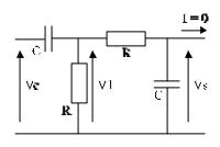
Le montage est alimenté par une tension sinusoï dale. Calculer la fonction de transfert complexe  $H(j\omega)$  du montage puis en déduire sa norme  $H(\omega) = \left|V_S \middle/ V_E\right|$ .
