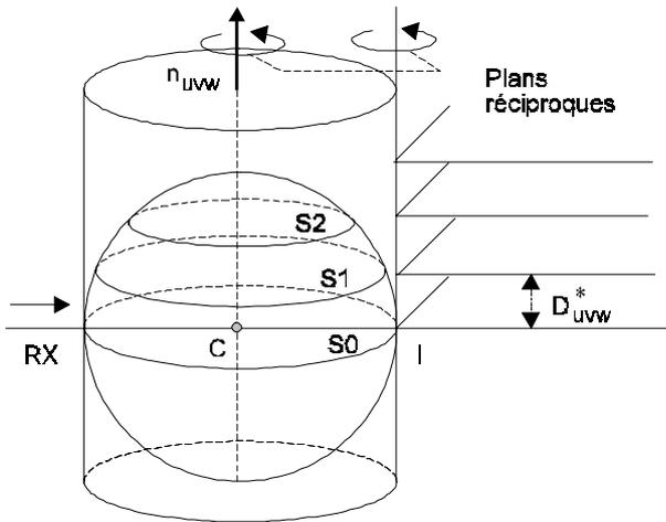
Les rayons diffractés sont donc répartis sur une série de cônes de révolution de sommet C et s'appuyant sur les cercles  $S_0, S_1, S_2$  dont les rayons sont donnés par :  $R_p = \sqrt{R^2 - p^2 \cdot D_{uvw}^2}$
